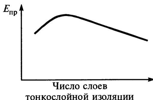
Рис. 2.48. Зависимость  $E_{пр}$  тонкослойной изоляции от числа слоев [2]
