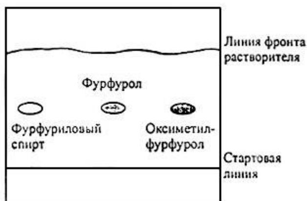
Рис. 25. Тонкослойная хроматография фурановых производных на силикагеле при элюировании в хлористом метиле
