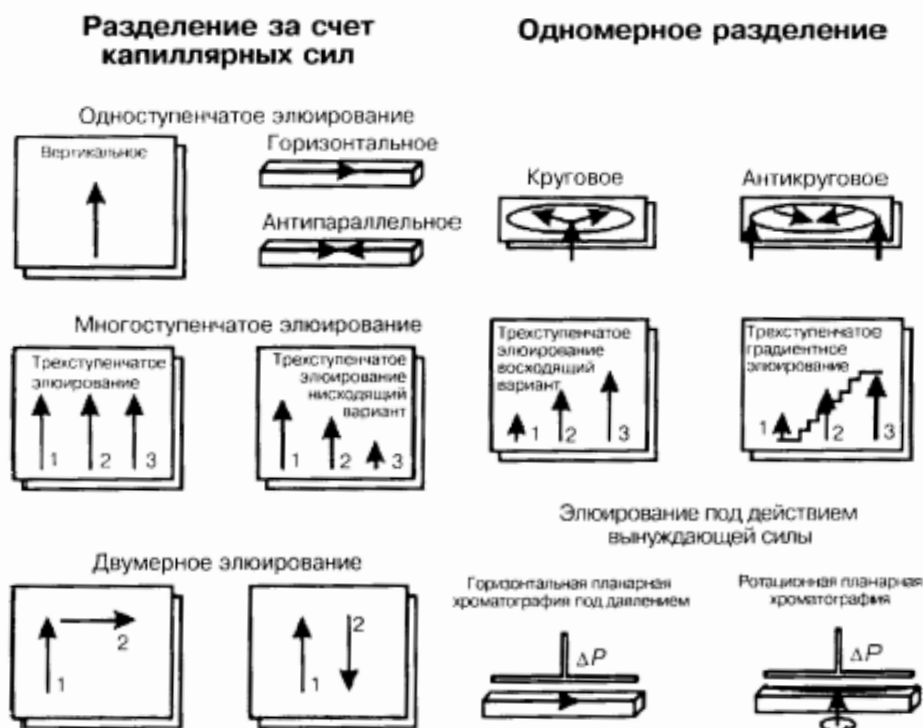
Рис. 7. Варианты элюирования компонентов в тонкослойной (планарной) хроматографии
