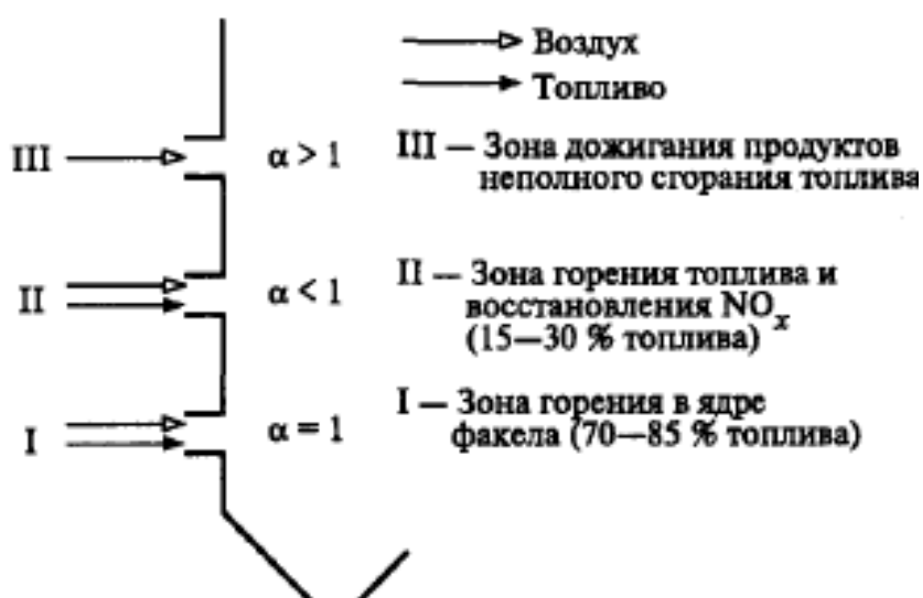
Рис. 2.19. Принципиальная схема трехступенчатого сжигания топлива в топке котла ( \alpha – избыток воздуха)
