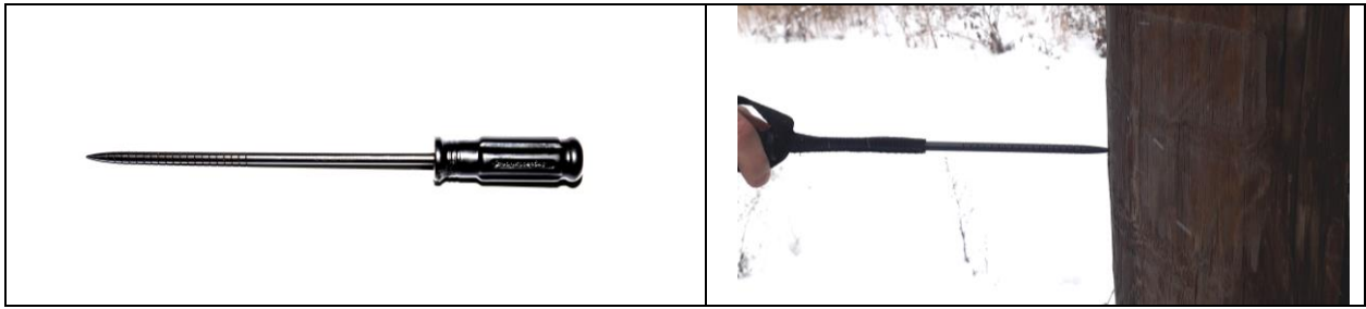
Рис. 1.3. Внешний вид щупа для измерения прочности деревянных опор и его применение
