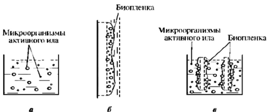
Рис. 2. Способы размещения микроорганизмов в сооружениях биологической очистки: а – активный ил в аэротенке; б – биопленка в биофильтре; в – активный ил и биопленка в биотенке [2]
