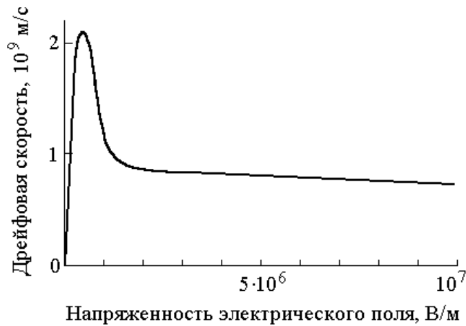
Рис. 11. Зависимость дрейфовой скорости электронов в GaAs от напряженности электрического поля
