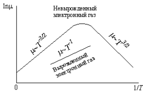
Рис. 29. Зависимость подвижности носителей заряда от температуры
