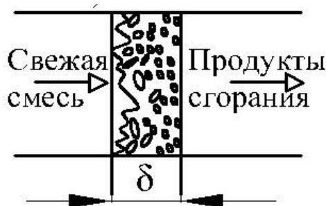
Рис. 5.14. Схема пламени при крупномасштабной турбулентности [1]
