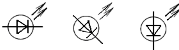
Рис. 3.9. Изображение положения квалифицирующих символов при повороте УГО
