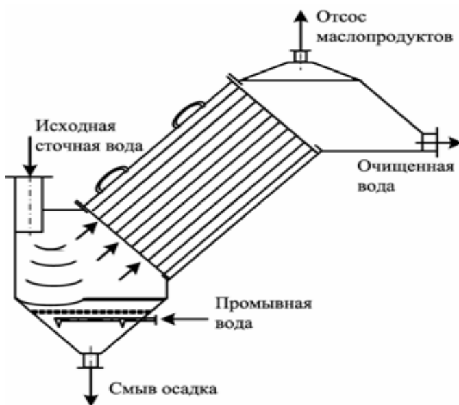
Рис. 1.25. Схема многоярусного отстойника нефтеловушки
