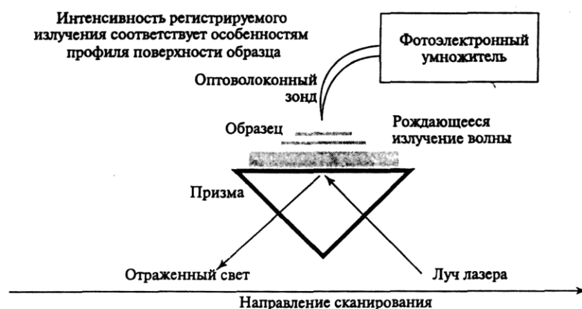
Рис. 4.1.3.3. Принцип работы сканирующего оптического микроскопа ближнего поля
