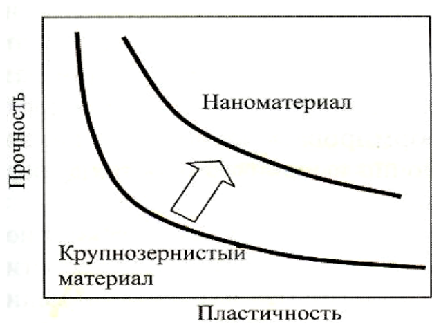
Рис. 2.1.1. Разница в интервале изменения механических свойств металлов (по А.М. Глезеру) с крупно- и нанозернистой структурой
