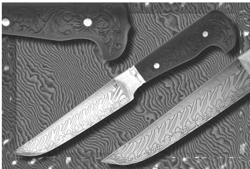
Рис. 5. Клинки из булатной стали
