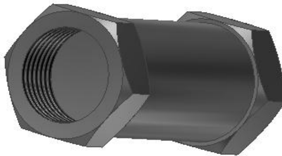
Рис. 3.39. Создание отверстия с резьбой ограниченной глубины
