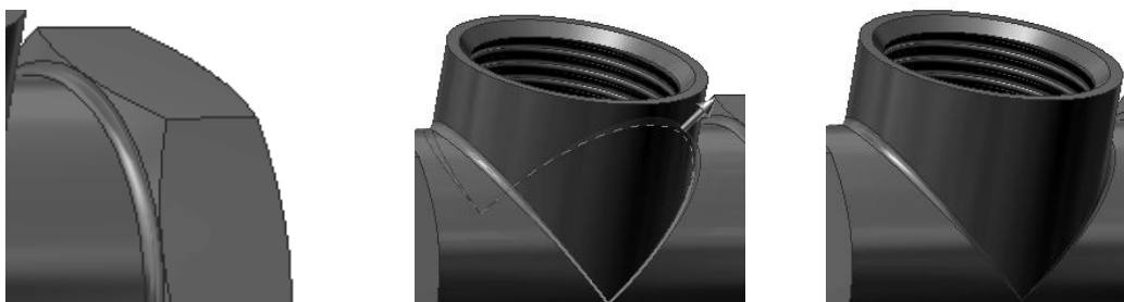
Рис. 3.59. Построение внешних скруглений ребер
