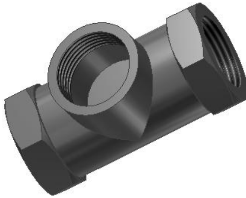
Рис. 3.43. Построение резьбового отверстия
