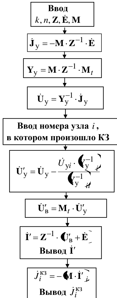
Рис. 3.7. Блок-схема алгоритма расчета токов трехфазного короткого замыкания методом узловых напряжений и методом наложения
