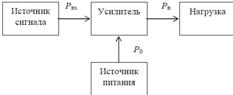
Рис. 3.1. Блок-схема усилителя
