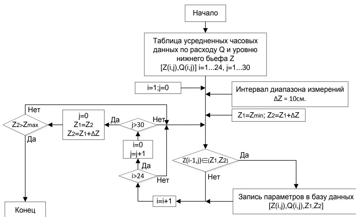
Рис 2.7. Алгоритм определения уровня нижнего бьефа
