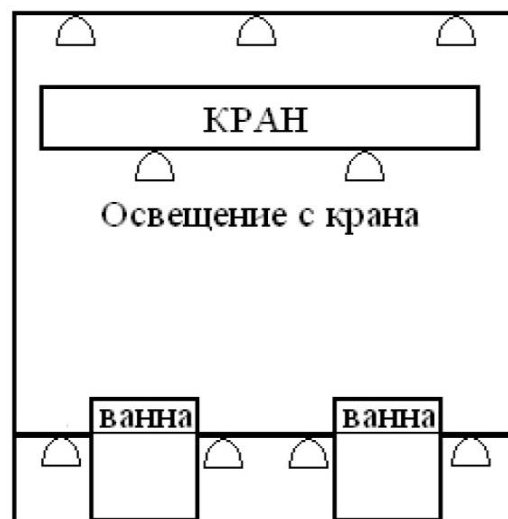
Рис. 4.4. Схема размещения светильников в цехе электролиза алюминия
