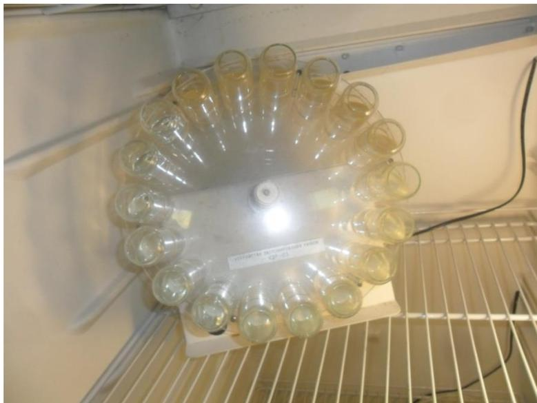
Рис. 3.16. Пробы с дафниями в устройстве экспонирования рачков
