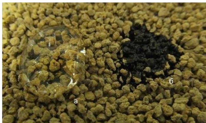
Рис. 2.16. Гидрофобный эффект гранул «СМ–5»: а – капля воды; б – капля нефтепродукта
