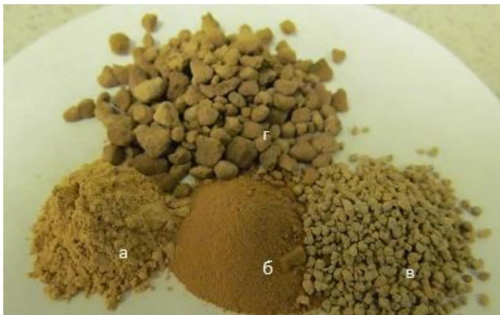
Рис. 2.20. Адсорбенты на основе карбонатного шлама: а – исходный шлам; б – «СМ-1»; в – «СМ-5»; г – «СМ-3»
