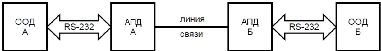
Рис. 10.2. Полная схема соединения по RS-232
