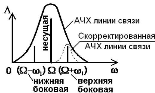
Рис. 6.13. Спектр амплитудно-модулированного сигнала
