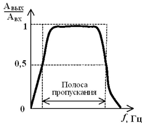
Рис. 6.5. Амплитудно-частотная характеристика канала связи
