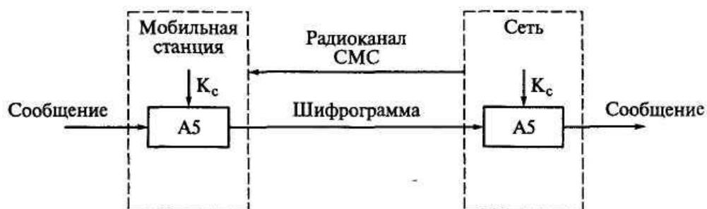
Рис. 12.8. Шифрация сообщений в соответствии со стандартом *GSM*
