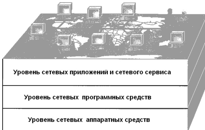
Рис. 13.13. Обобщенная структура вычислительной сети
