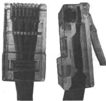
Рис. 4.4. Коннекторы *RJ-45* для подключения витой пары к узлу вычислительной сети
