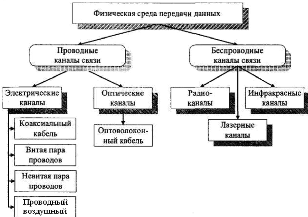
Рис. 4.1. Классификация каналов передачи данных
