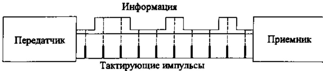
Рис. 6.16. Синхронизация приемника и передатчика на небольших расстояниях
