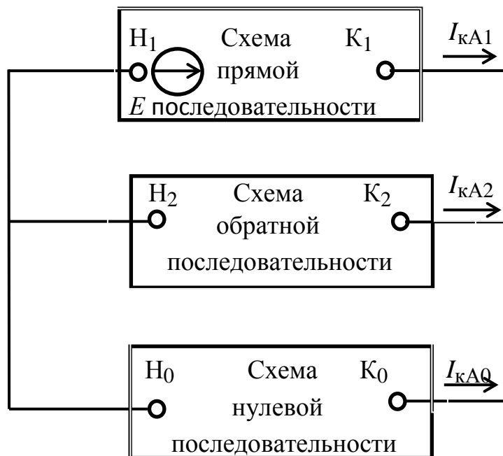
Рис. 4.2. Комплексная схема замещения для двухфазного КЗ на землю
