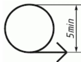
Рис. 5.21. Условное графическое обозначение «развернуто»
