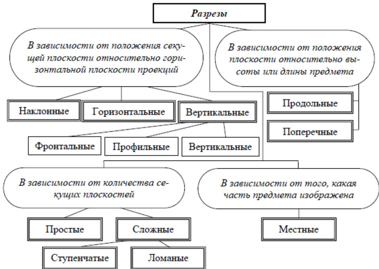
Рис. 2.2. Классификация разрезов
