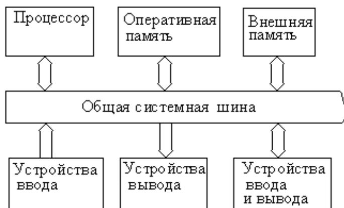
Рис. 1.1. Система объединения устройств посредством общей шины
