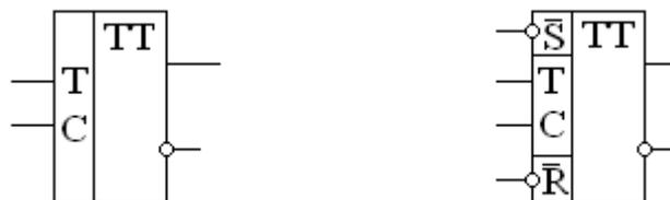
Рис. 4.36. Обозначение T-триггера в схемах. Слева синхронный T-триггер, справа синхронный T-триггер с входами установки и сброса
