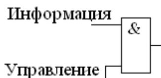
Рис. 4.25. Схема И в качестве вентиля
