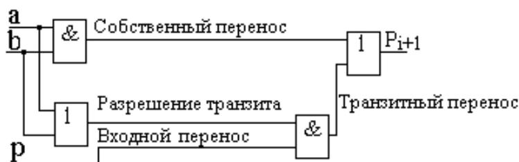
Рис. 7.5. Схема переноса с цепями транзита и собственного переноса
