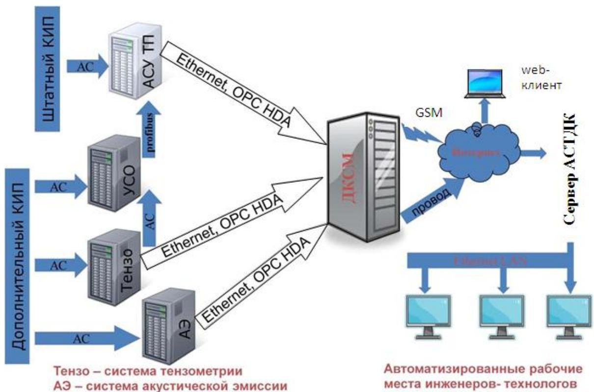
Рис. 2.5. Схема информационных потоков в АСТДК
