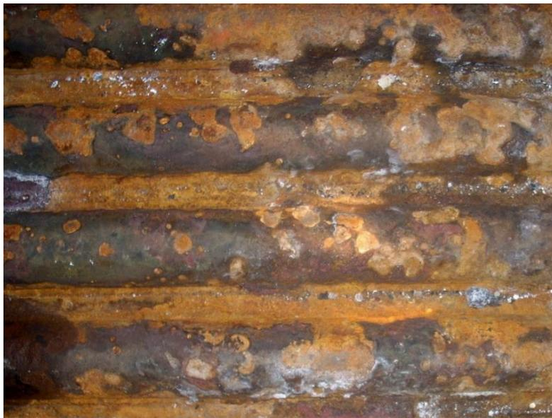
Рис. 3.26. Наружная язвенная коррозия труб подового экрана
