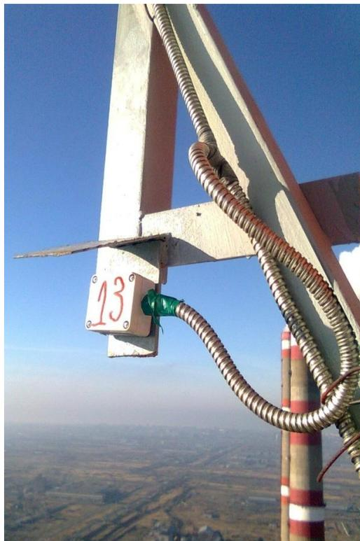
Рис. 4.3. Датчик температуры воздуха на дымовой трубе
