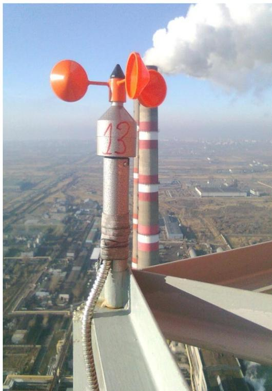
Рис. 4.1. Датчик анемометра АСЦ-3
