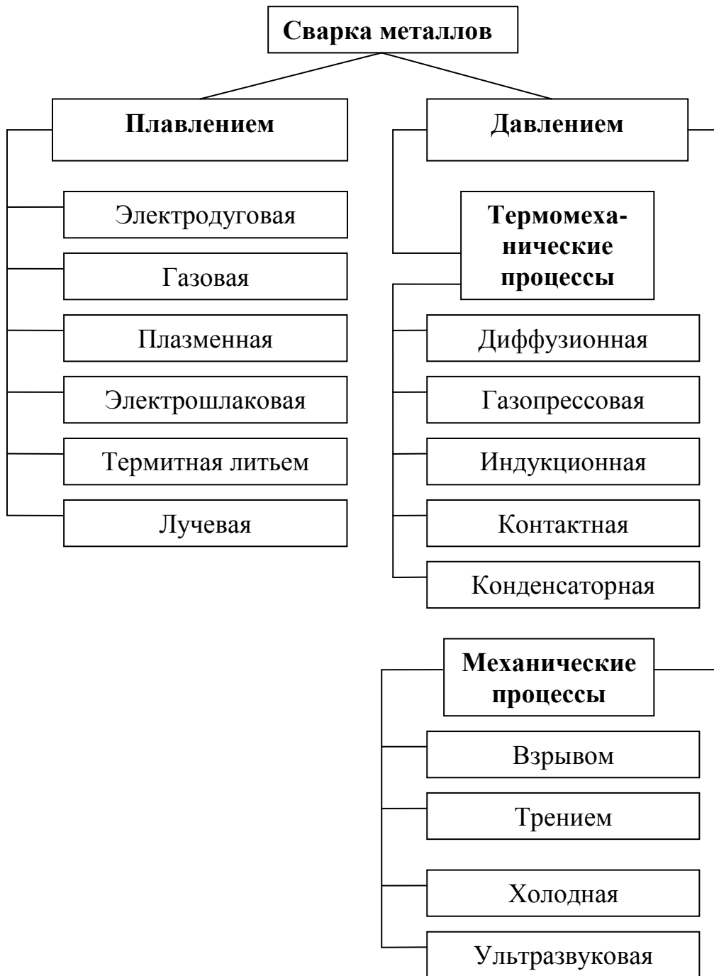
Рис. 16.4. Классификация способов сварки
