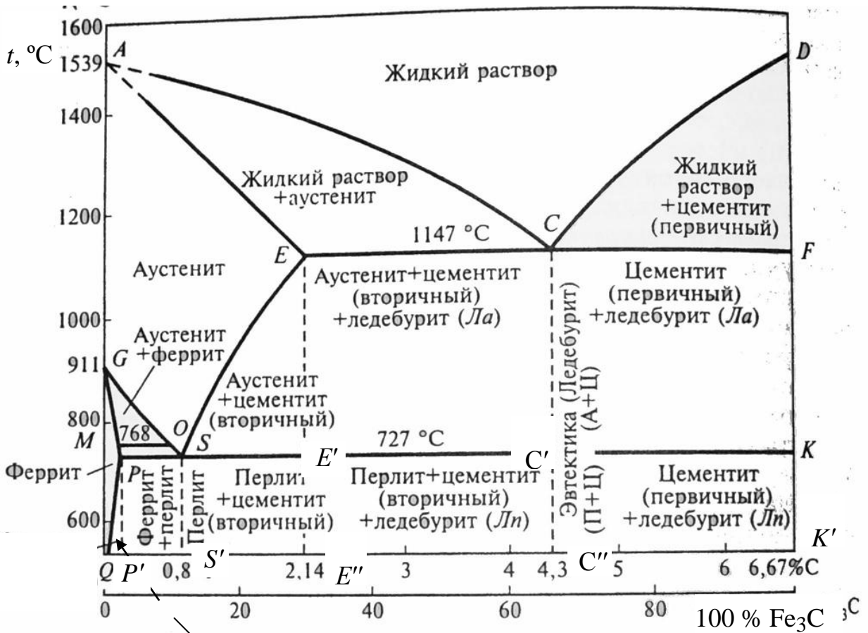
Рис. 6.1. Диаграмма состояния железоуглеродистых сплавов [4]
