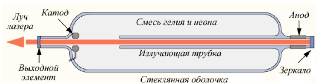
Рис. 2.33. Устройство гелий-неонового лазера
