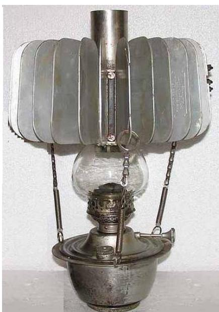
Рис. 1.21. Термогенератор ТГК-3
