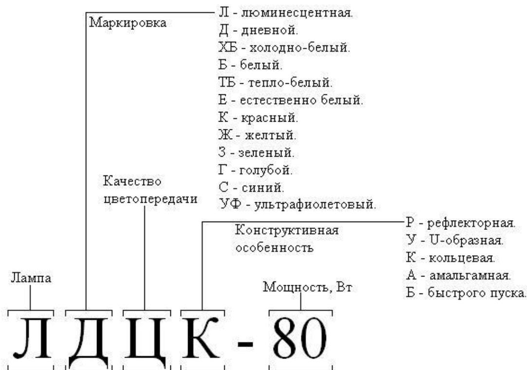
Рис. 2.2. Маркировка отечественных люминесцентных ламп
