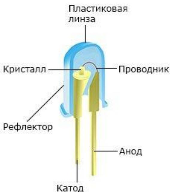
Рис. 3.7. Конструкция светодиода мощностью 0,5 Вт и диаметром 5 мм
