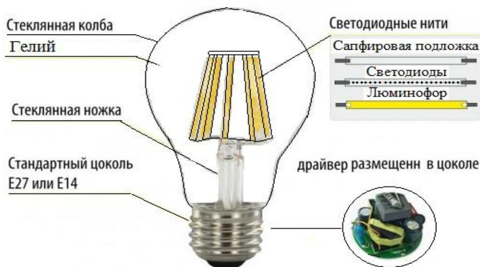
Рис. 3.16. Конструкция Filament-лампы
