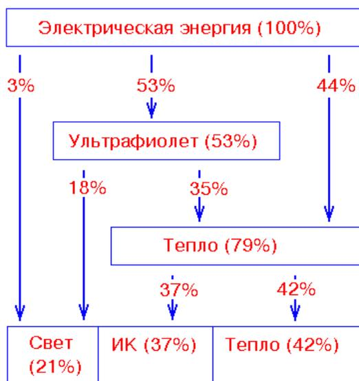
Рис. 2.9. Энергетический баланс люминесцентных ламп
