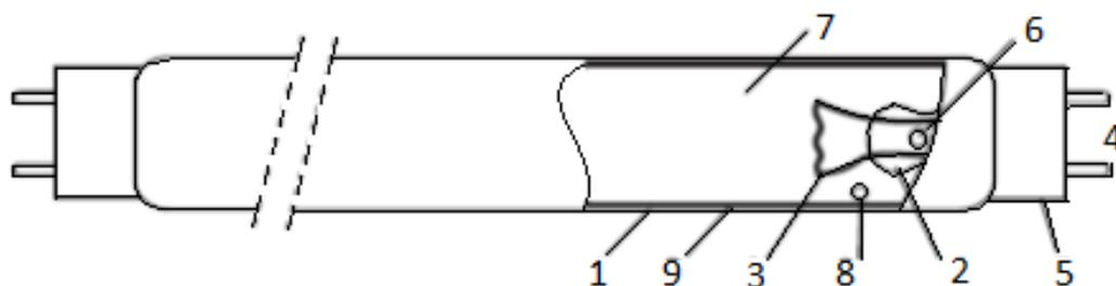
Рис. 2.3. Устройство газоразрядной трубчатой люминесцентной лампы:
