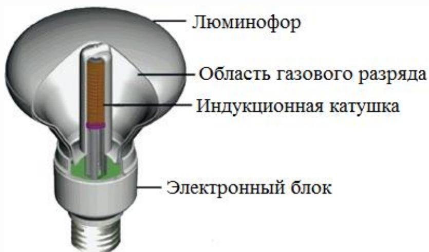
Рис. 2.15. Индукционная лампа с магнитным сердечником внутри колбы
