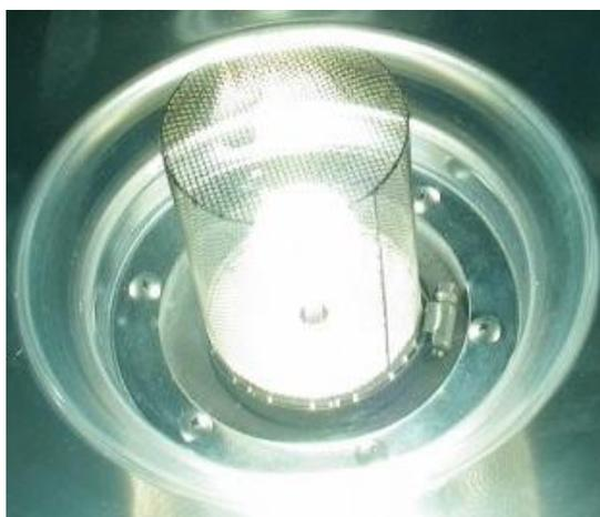
Рис. 2.25. Внешний вид серной лампы
