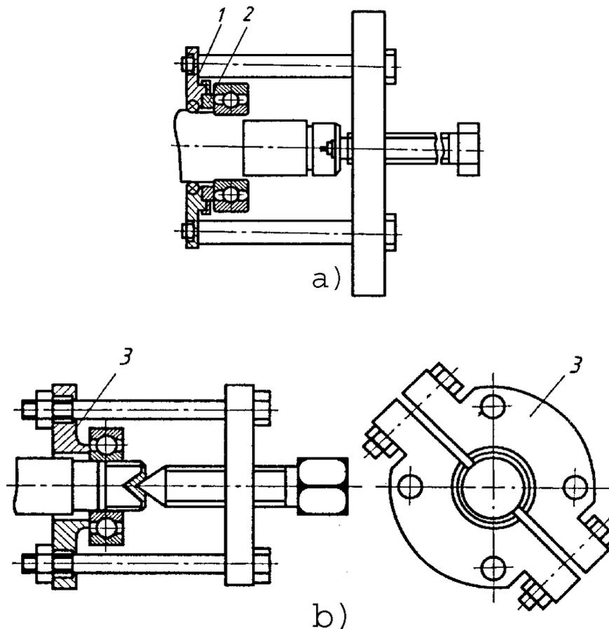
Рис. П.4. Схема снятия подшипников с использованием вставок (а) и хомута (б):
