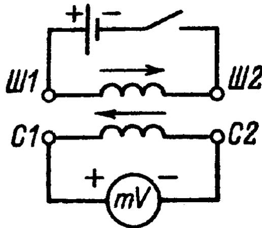
Рис. 44. Проверка согласованности обмоток главных полюсов импульсным методом
