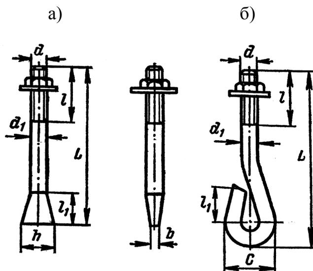
Рис. 18. Фундаментные болты для крепления мелких и средних электрических машин:
