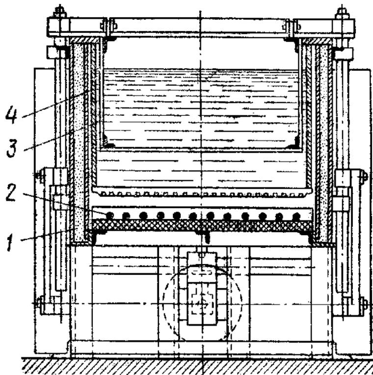
Рис. П.22. Схема масляной ванны для нагрева подшипников:
