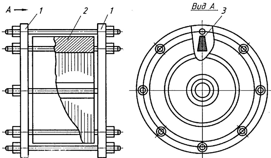
Рис. П.15. Приспособление для снятия сердечника с вала:
