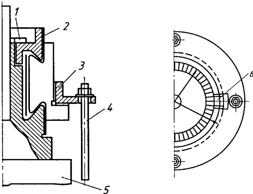
Рис. П.16. Приспособление для замены коллекторных пластин:
