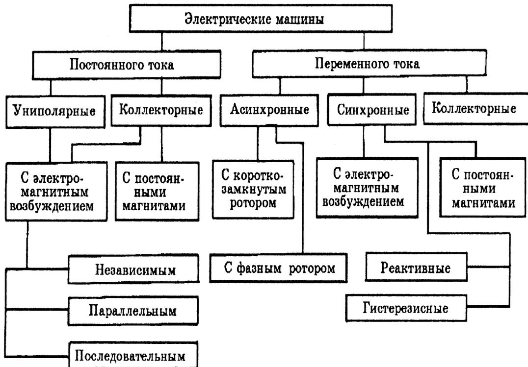
Рис. 1. Классификация электрических машин
