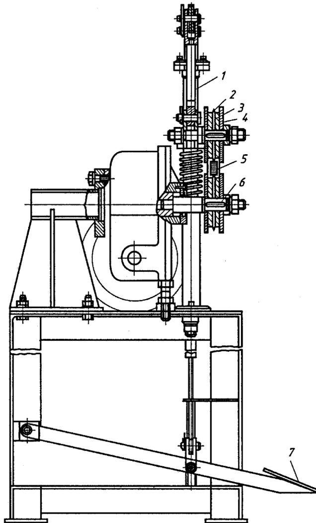
Рис. П.18. Станок для удаления корпусной изоляции катушек:
