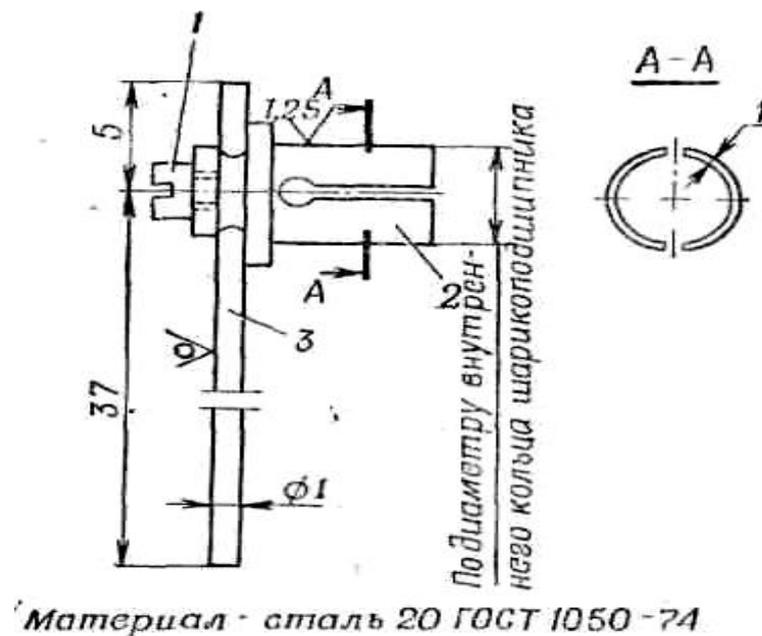
Рис. 89. Оправка для проверки момента трения подшипников:
