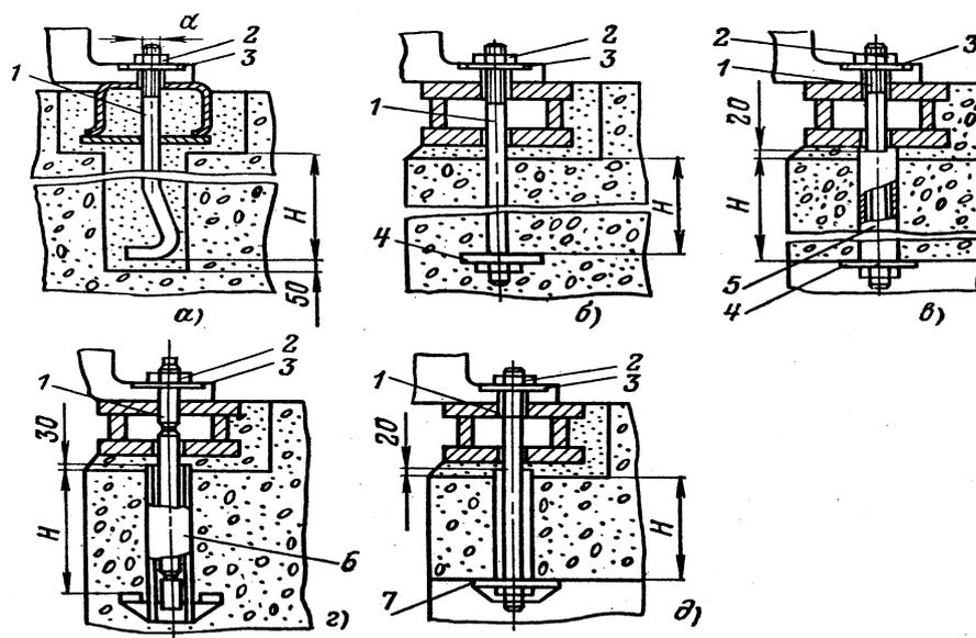
Рис. 31. Установка фундаментных болтов (а, б – крепление глухое; в, г, д – крепление съемное): 1 – фундаментный болт; 2 – гайка; 3 – шайба; 4 – плита; 5 – труба; 6 – арматура анкерная; 7 – плита анкерная
