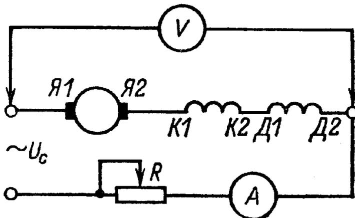
Рис. 47. Схема проверки правильности соединения обмоток дополнительных полюсов и компенсационной обмоткой якоря
