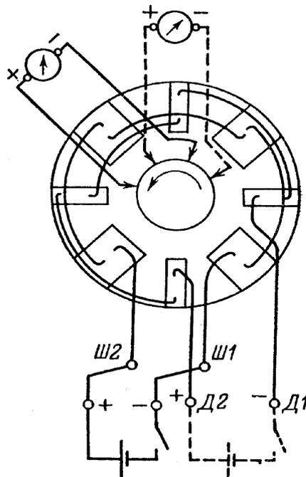
Рис. 49. Проверка чередования основных и дополнительных полюсов на собранном возбуждателе
