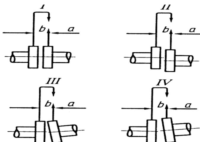
Рис. 24. Взаимное расположение валов машин, соединяемых с помощью муфт:
