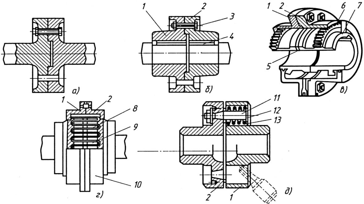
Рис. 19. Соединение валов (а) и муфт (б – жесткой поперечно-свертной; в – зубчатой; г – полужесткой зубчато-пружинной; д – упругой втулочно-пальцевой):
