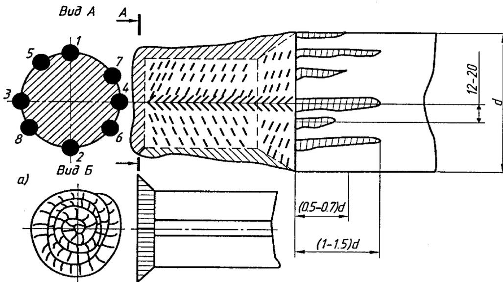
Рис. 62. Восстановление посадочной поверхности вала (а) и его торца электродуговой наплавкой (б)
