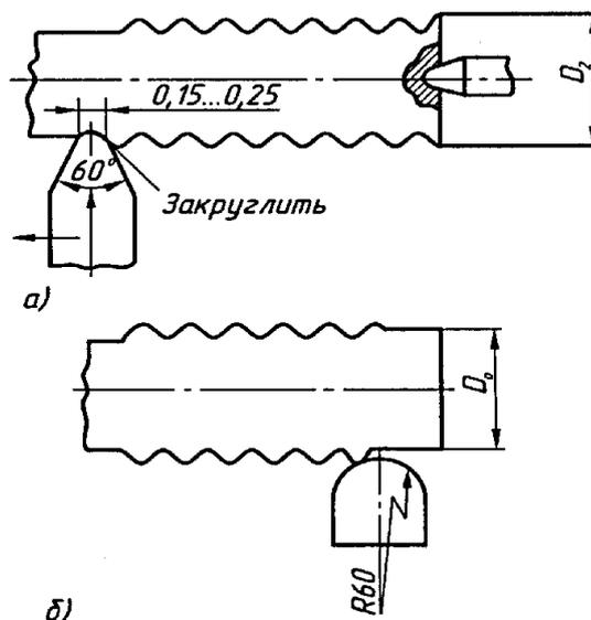
Рис. 64. Ремонт валов высадкой (а) и сглаживанием (б)
