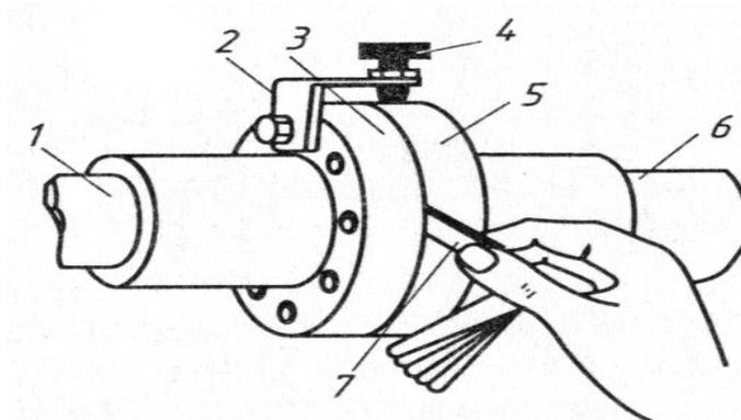
Рис. 27. Центровка валов способом «обхода одной точки»:
