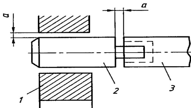
Рис. 66. Установка вставки стержня сварной короткозамкнутой обмотки:
