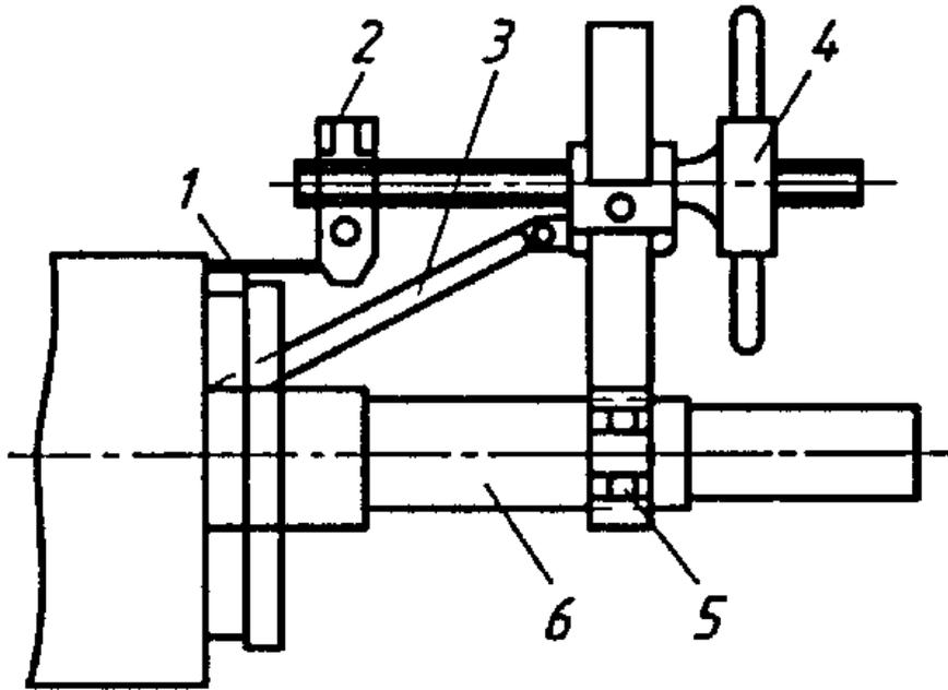
Рис. П. 13. Приспособление для извлечения стержней из пазов ротора:
