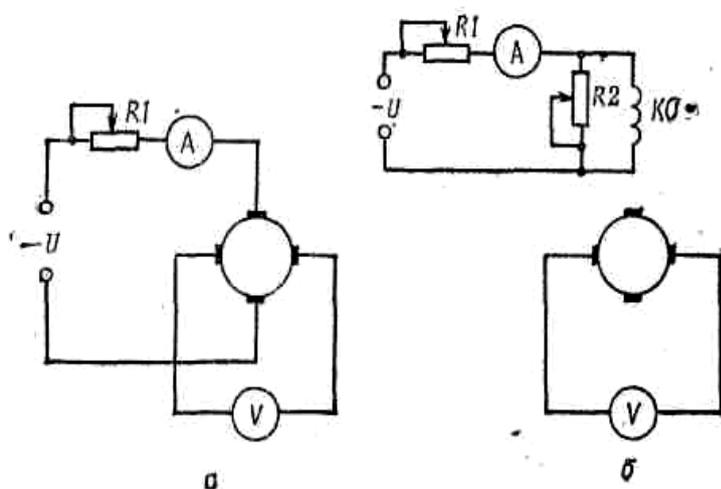
Рис. 81. Схема для установки степени компенсации ЭМУ:
