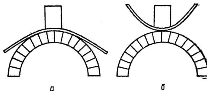
Рис. 78. Пришлифовка щеток: а – правильно; б – неправильно
