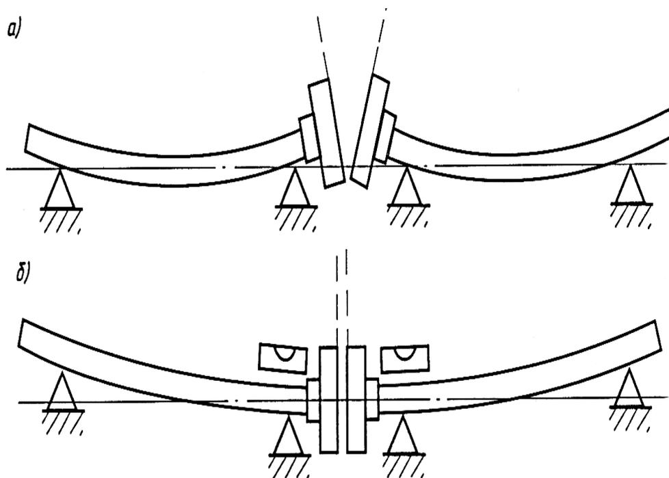
Рис. 34. Положение валов, соединяемых с помощью полумуфт:
