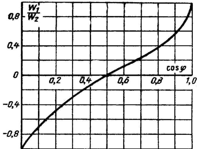
Рис. 53. Кривая для определения  $\cos \varphi_0$  по отношению показаний двух ваттметров
