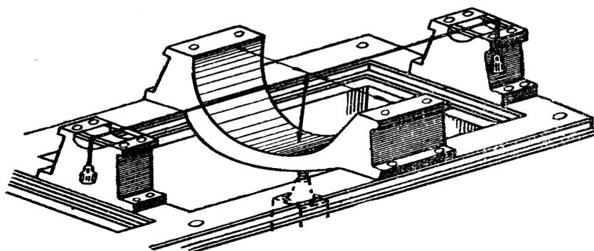
Рис. 32. Выверка подшипниковых стоек и магнитной системы
