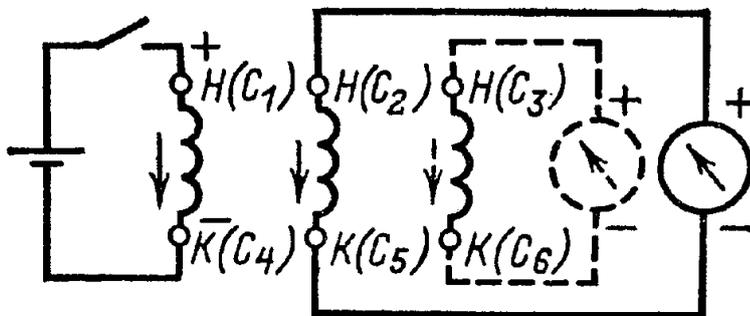
Рис. 41. Определение полярности обмоток электродвигателя
