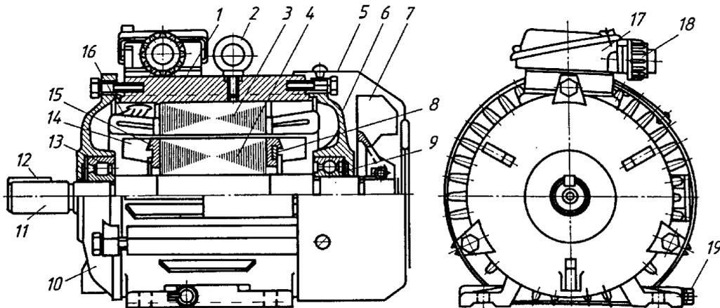
Рис. 56. Асинхронный двигатель с короткозамкнутым ротором:
