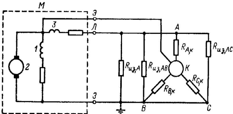
Рис. 38. Схема измерения сопротивления  $R_{из}$  обмоток статора генератора с водяным охлаждением;  $R_{из, A}$  – сопротивление изоляции фазы  $A$  по отношению к корпусу;  $R_{из, AB}$ ;  $R_{из, AC}$  – то же по отношению к фазам  $B$  и  $C$ ;  $R_{A, к}$ ,  $R_{B, к}$ ,  $R_{C, к}$  – сопротивление шлангов фаз  $A$ ,  $B$  и  $C$ ;  $K$  – коллекторы системы охлаждения;  $M$  – мегаомметр; 1 – малая рамка; 2 – генератор; 3 – большая рамка; Л, З, Э – зажимы
