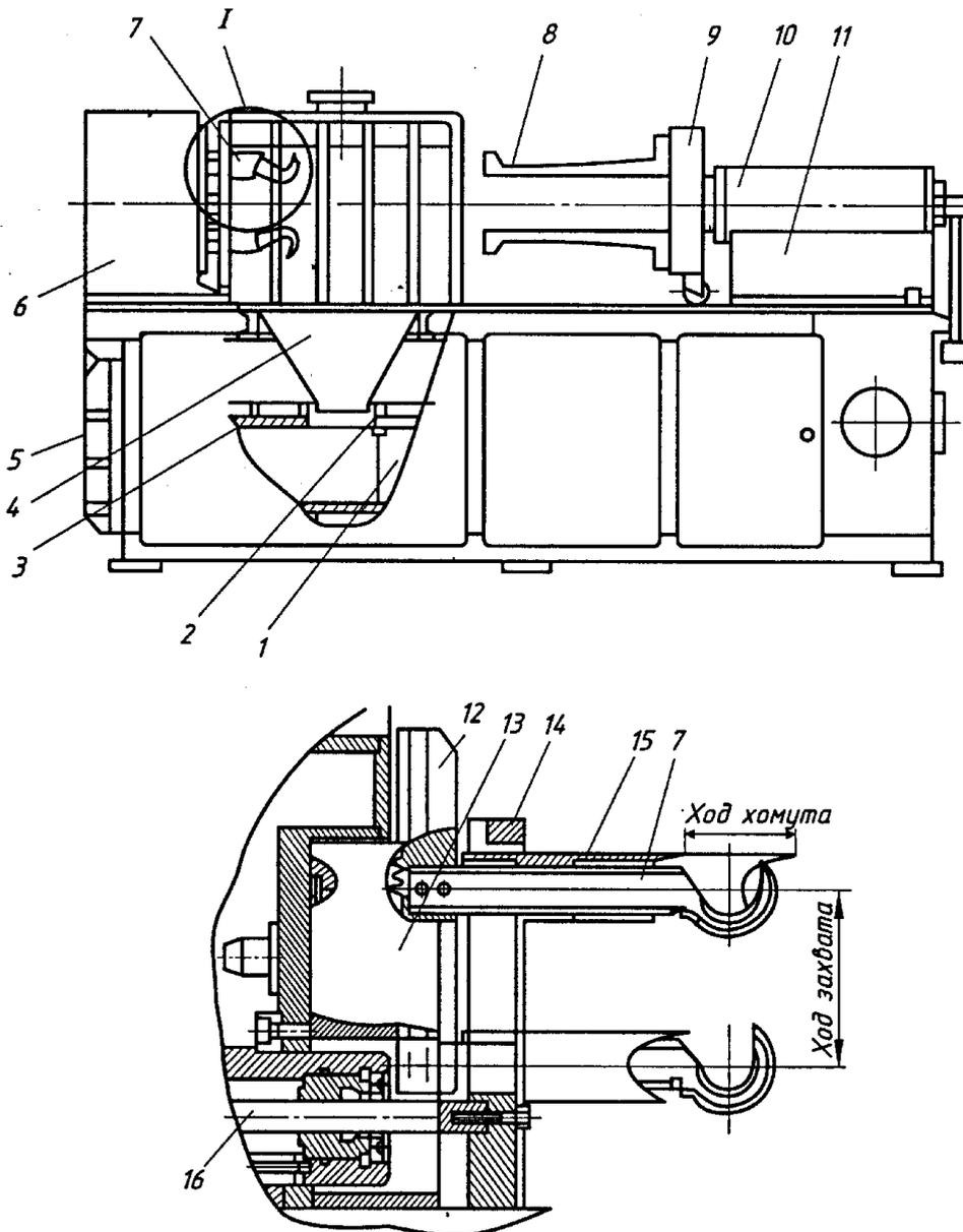
Рис. П.12. Станок типа УПО-1 для удаления обмотки из статоров:
