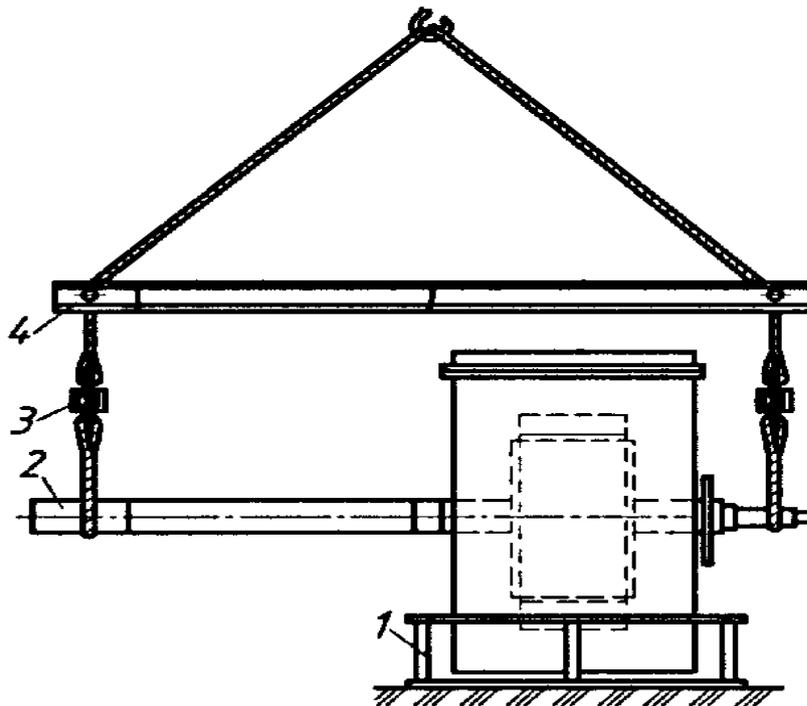
Рис. П.7. Приспособление для вывода ротора из статора:
