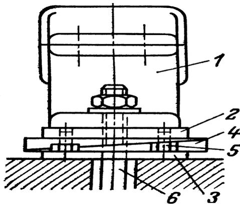
Рис. 30. Установка подшипникового стояка на отдельной фундаментной плите;
