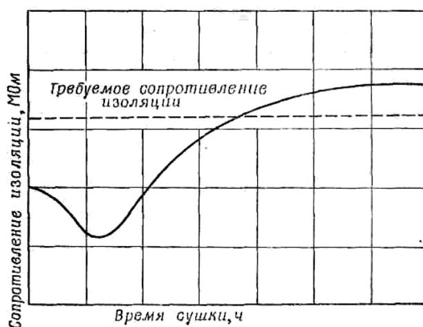
Рис. 79. График зависимости сопротивления изоляции от времени сушки
