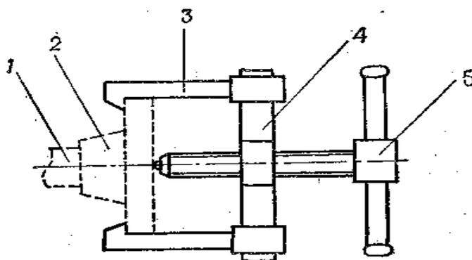
Рис. 71. Съемник: 1 – вал электродвигателя; 2 – полумуфта; 3 – захват; 4 – траверса; 5 – винт
