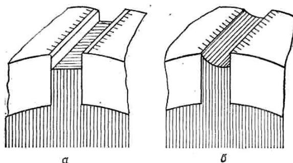
Рис. 77. Продороживание коллектора: *а* – правильно; *б* – неправильно
