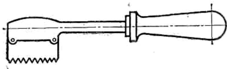
Рис. 76. Ручная пилка для продороживания коллектора
