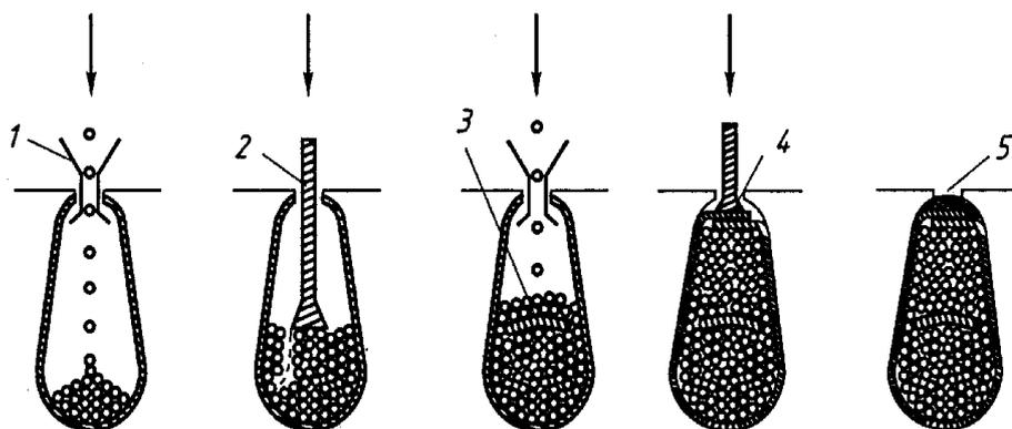
Рис. 68. Схема «всыпания» витков обмотки в паз:
