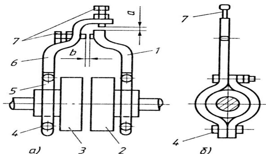
Рис. 25. Центровка валов с помощью радиально-осевых скоб:
