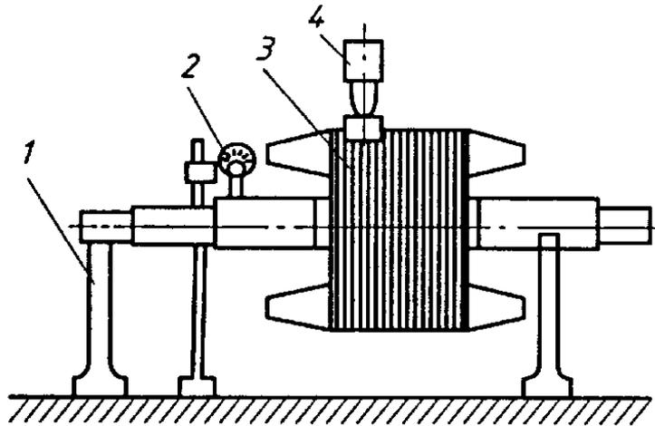
Рис. 65. Схема исправления кривизны вала:
