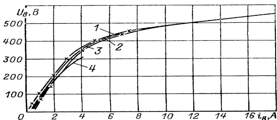
Рис. 50. Характеристика холостого хода и нагрузочная возбудителя синхронного генератора типа ВТ170-3000: 1,2 – нисходящая и восходящая ветви; 3 – усредненная характеристика ХХ; 4 – нагрузочная характеристика
