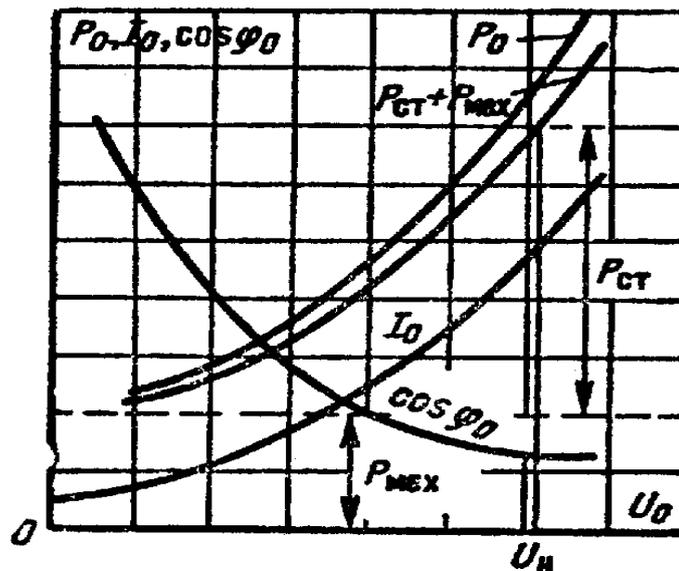
Рис. 51. Характеристика холостого хода асинхронного двигателя
