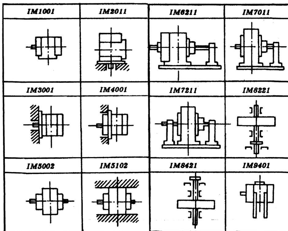
Рис. 2. Формы исполнения электрических машин
