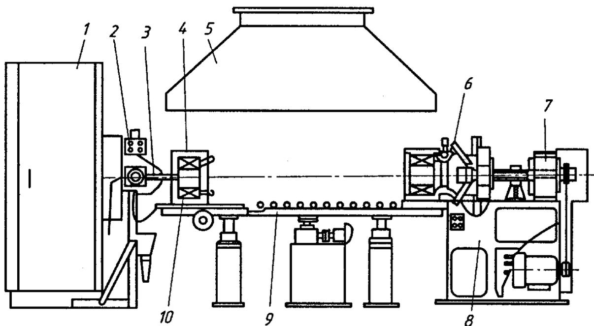
Рис. П.11. Схема высокочастотной установки для разогрева и извлечения обмотки статора: 1 – генератор; 2 – пульт управления; 3 – зажим; 4 – статор; 5 – вытяжной зонтик; 6 – крючки; 7 – пневматический цилиндр; 8 – механизм выдергивания; 9 – рольганг; 10 – индуктор
