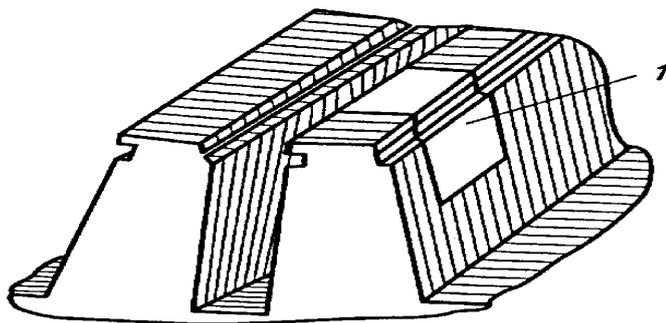
Рис. 59. Схема установки вставки в зуб сердечника
