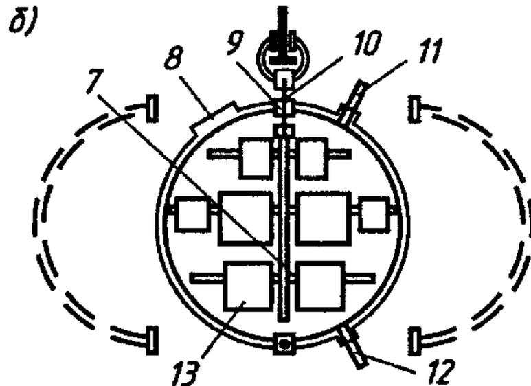
Рис. П.19 (б). Полуавтоматическая установка АВБ-4 для пропитки под вакуумом и давлением схема автоклава и подвески: 7– подвеска; 8 – смотровое окно; 9 – уплотнения; 10 – металлическая пластина; 11, 12 – штуцера; 13 – предназначенный для пропитки статор (ротор)
