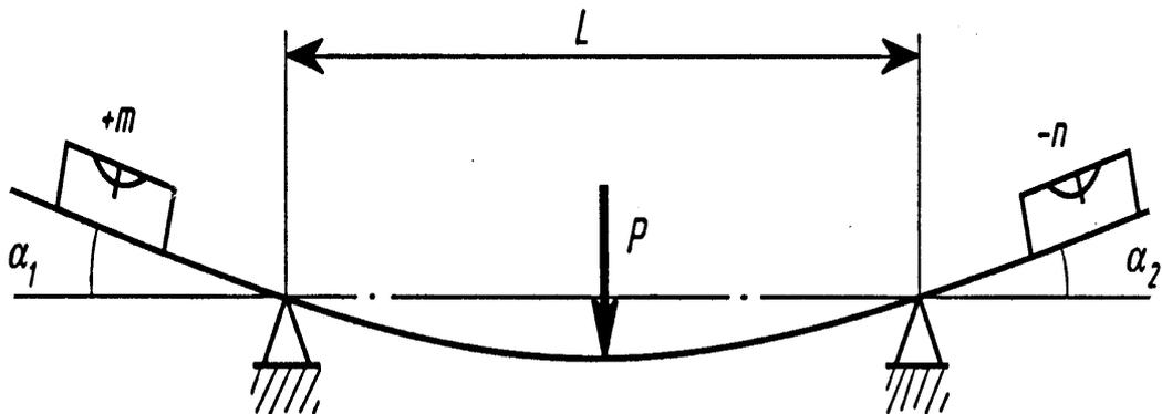
Рис. 33. Схема измерения углов поворота шеек вала
