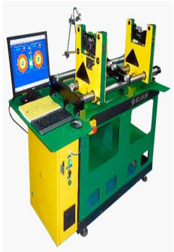
Рис. П.21. Универсальный балансировочный станок:
