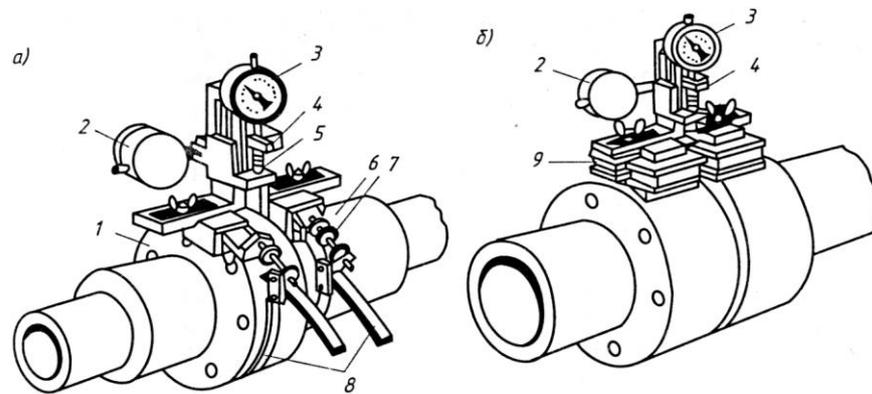
Рис. 26. Приспособления с ленточным (а) и электромагнитным (б) прижимами;:
