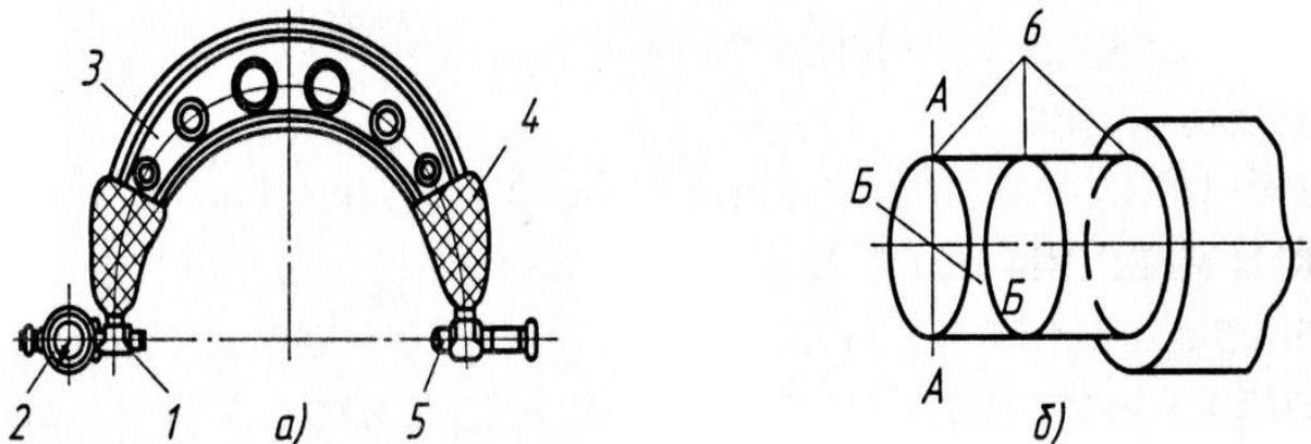
Рис. 20. Скоба с отсчетным устройством (а) и определение посадочных размеров конца вала (б): 1, 5 – подвижная и переставная пятки; 2 – отсчетное устройство; 3 – корпус; 4 – теплоизоляционная накладка; 5 – места измерений
