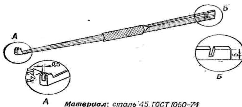
Рис. 90. Регулировочная лапка
