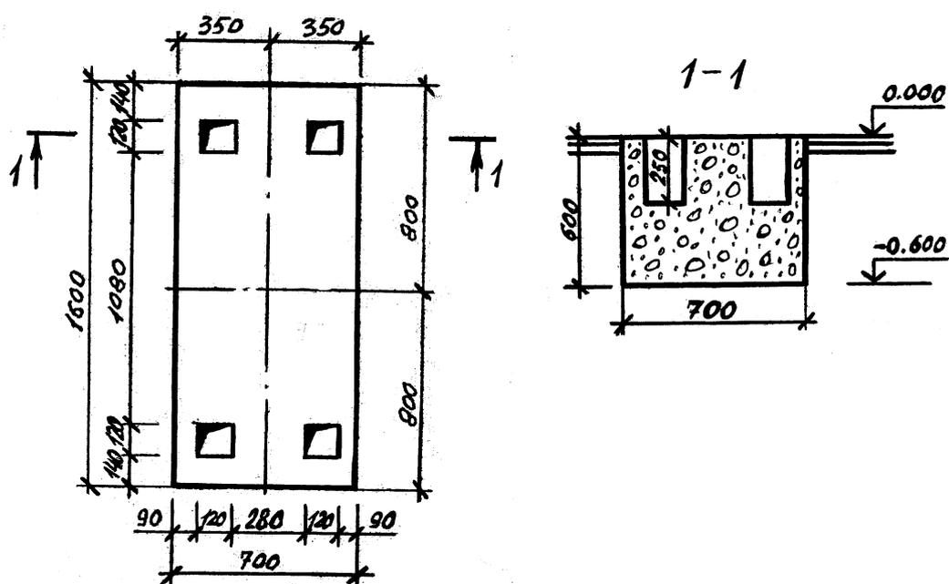
Рис. 14. Фундамент под электрические машины и технологическое оборудование
