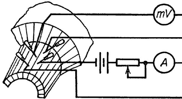
Рис. 39. Схема проверки состояния коллекторных пластин машин постоянного тока
