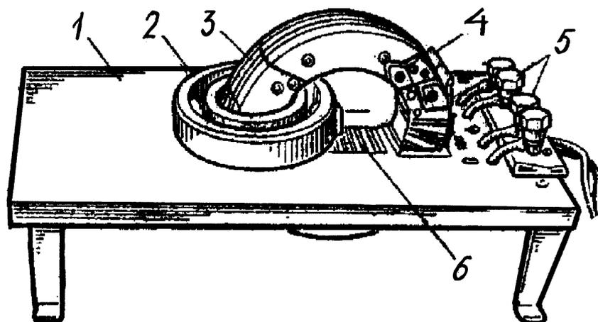
Рис. П.23. Установка индукционного нагрева подшипников:
