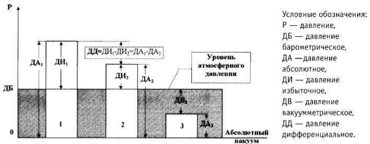
Рис. 1.14. Виды измеряемых давлений в точках 1, 2, 3 физического процесса
