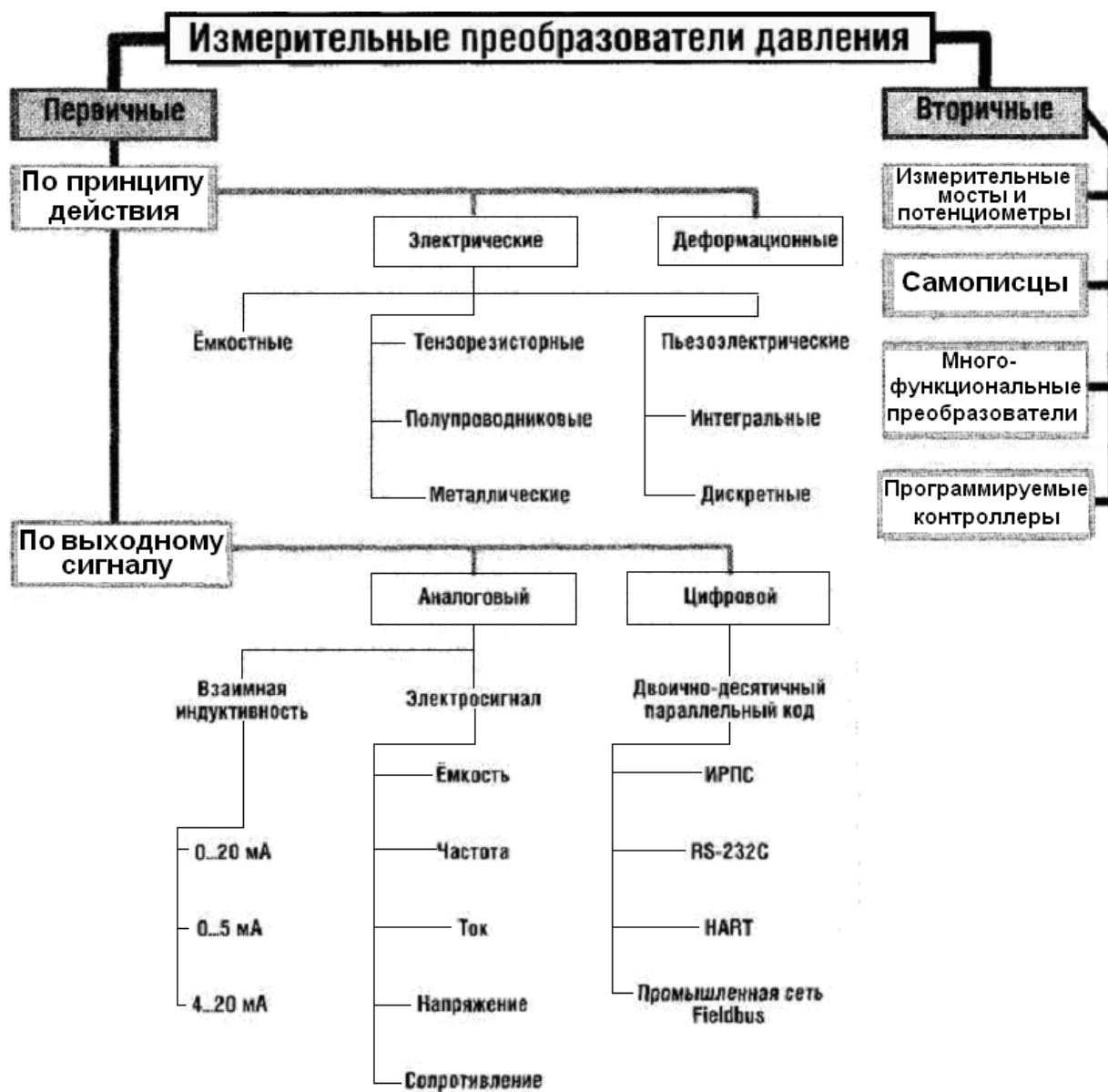
Рис. 1.16. Классификация измерительных преобразователей давления
