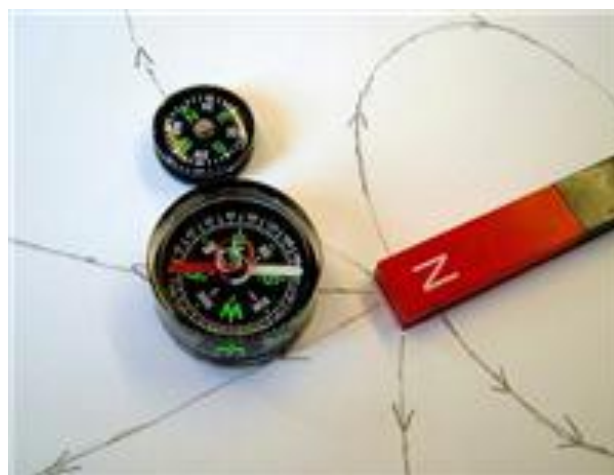
Рис. 1.1.2. Компасная стрелка поворачивается магнитом: ее южный полюс стремится повернуться к северному полюсу магнита
