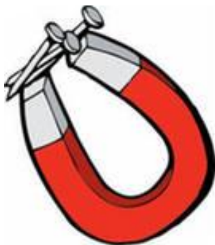
Рис. 1.1.1. Подковообразный магнит притягивает железные тела.
