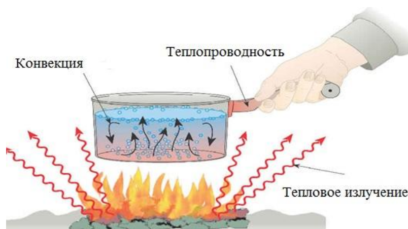
Рис. 3.1. Распространение теплоты в пространстве
